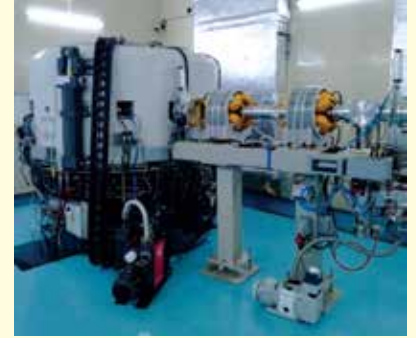
ক্যান্সার নির্ণয়ে ব্যবহৃত F18 FDG আইসোটোপ উৎপাদন যন্ত্র সাইক্লোট্রোন
