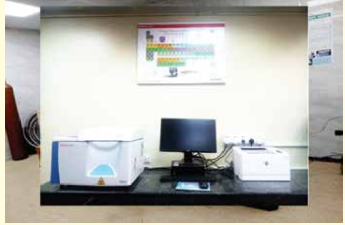
বায়ুতে বিদ্যমান বিষাক্ত ও ভারী ধাতুর গুণাগুণ নির্ণয়ে ব্যবহৃত EDXRF
